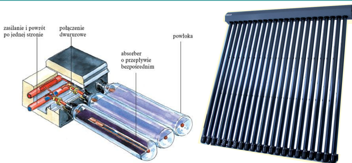
Rysunek 2.3. Budowa i wygląd – kolektor próżniowy
